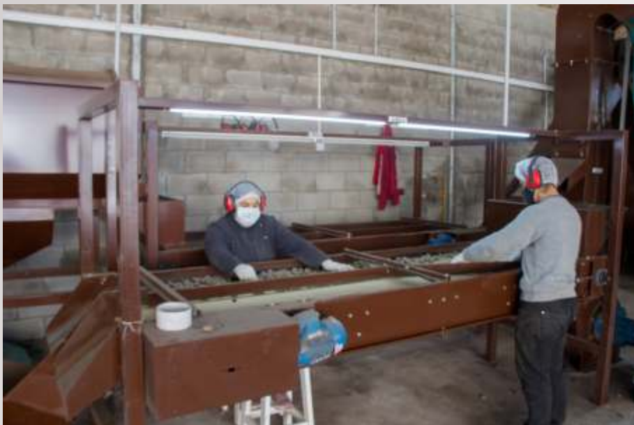
Operarios en mesa seca de inspección
