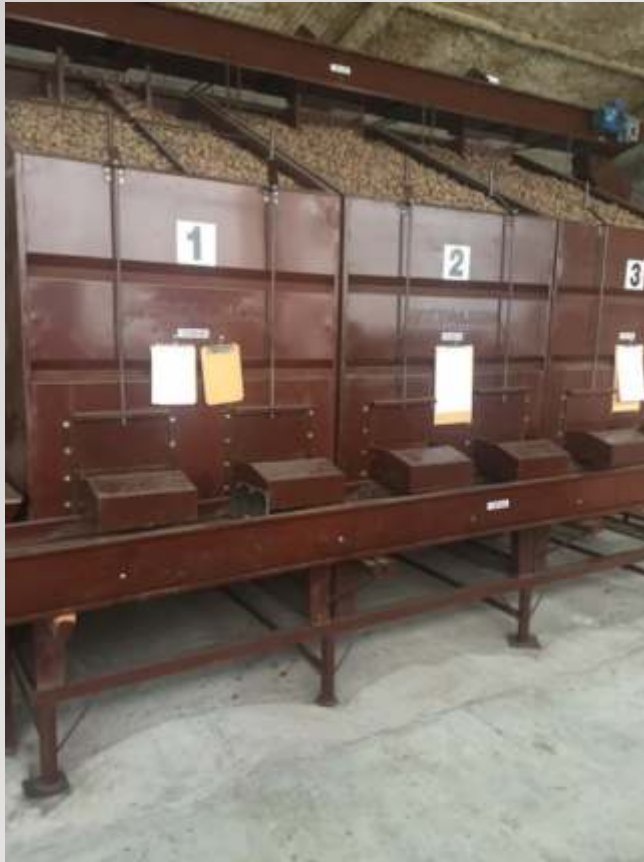
Secadoras de 1000 kg. con aire caliente
