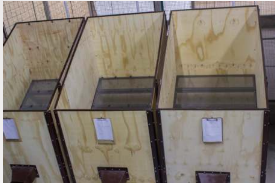
Pre secadero de fenólico de 1000 kg cada uno con aire natural
